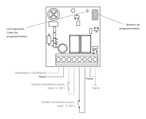
Le récepteur KING GATES FRED MYO 2 à une fréquence de 433.920MHz et à une mémoire de 480 codes.
